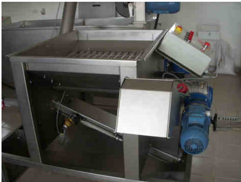
Foto 1. Sector de volcado de una planta procesadora de aceitunas
